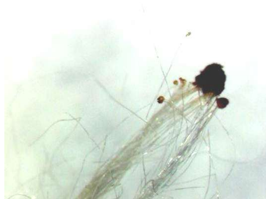
Мал. 43. Рэакцыя на спаленне шаўковай ніці: кантрольны ўзор натуральнага шоўку (а); даследуемае валакно (б)
