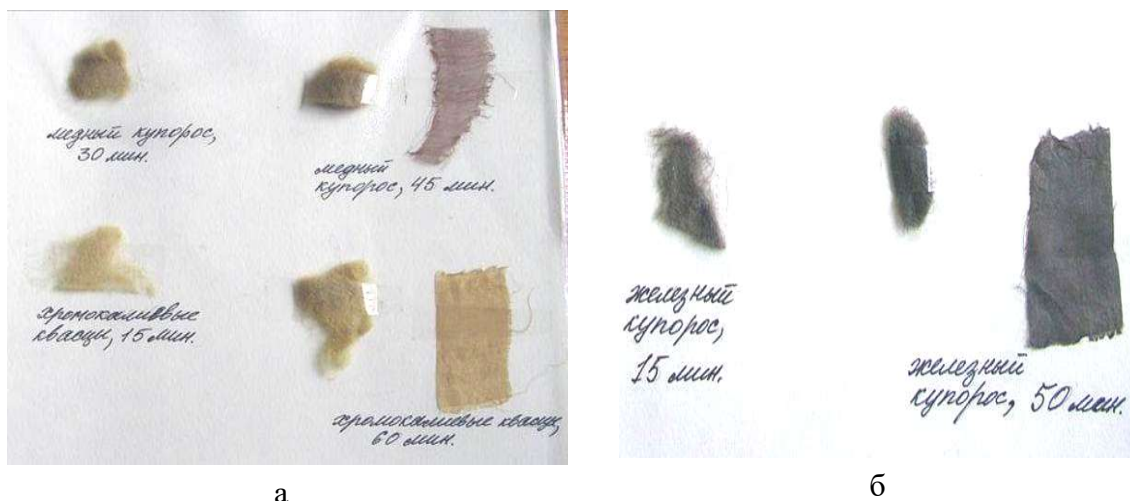
Мал. 42. Афарбоўка дубовай карой з рознымі пратравамі: медны купарос – 30 хвілін, 45 хвілін; хромакаліевыя квасцы – 15 хвілін, 60 хвілін (а); жалезны купарос – 15 хвілін, 50 хвілін (б)
