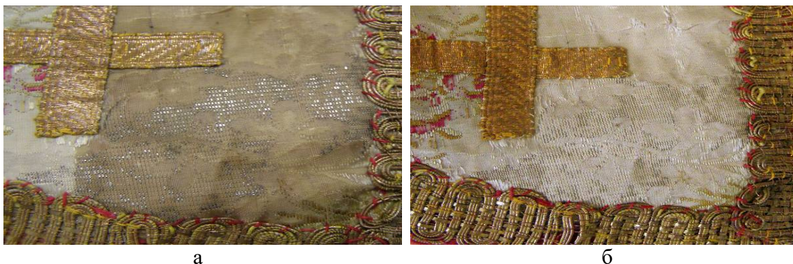
Мал. 50. Змякчэнне крохкай перасохлай тканіны з выкарыстаннем ПЭГ 2000 + ПЭГ 4000 (а); фрагмент праз 6 месяцаў пасля апрацоўкі (б)
