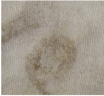
Мал. 48. Адбелванне пігментных плям цвілі і агульнага забруджання акісленнем перакісным сродкам Borma Wachs, Італія (а – да апрацоўкі; б – пасля апрацоўкі)
