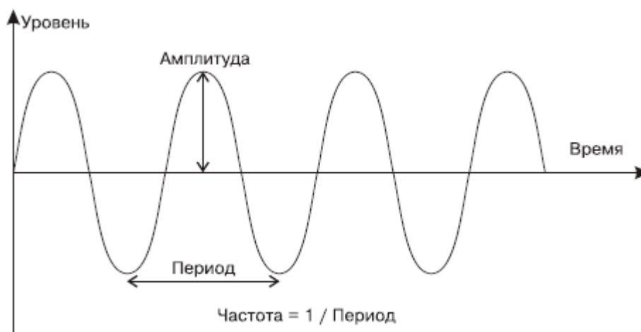
Рис. 1.3. Синусоида – график звуковых колебаний
