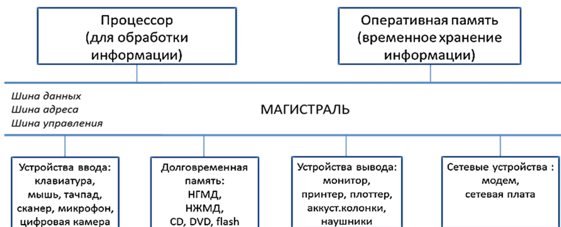
Рис. 5. Магистрально-модульный принцип построения компьютера
