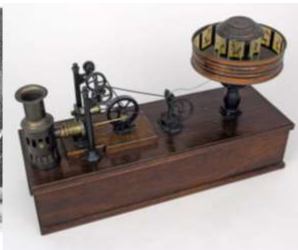
Рисунок 2.7 – Праксиноскоп, созданный Эрнстом Планком из Нюрнберга, Германия, работающий на миниатюрном воздушном двигателе. В настоящее время принадлежит Бирмингемскому научному музею
