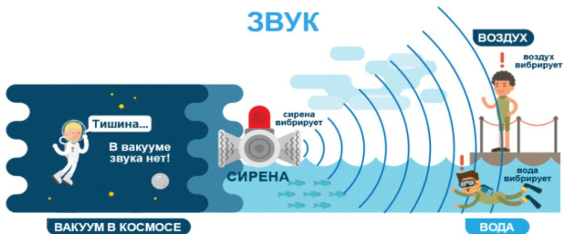
Рисунок 1 – Распространение звуковых волн
