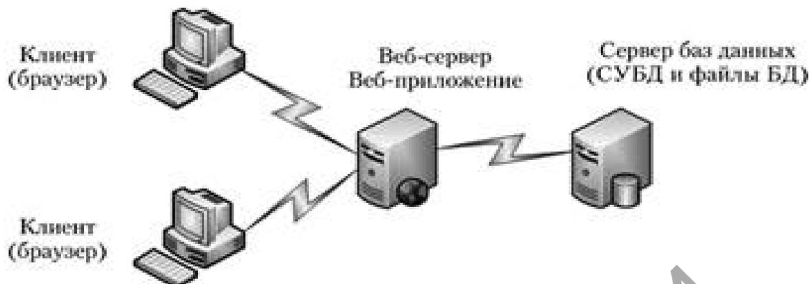
Рис. 1.12. Архитектура Интернет/Инtranет-решений
