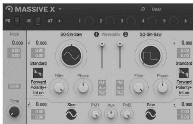
Рис. 2. Осциллятор музыкального синтезатора Massive X, с синусоидальной и прямоугольной формами волны
