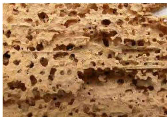
Малюнак 3.3.5 – Разбураная мэблявым тачыльшчыкам дошка абраза.
