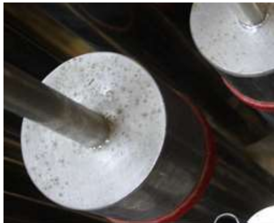
Мал. 4.1.1 – Калоніі цвілевых грибоў на элементах аргана сабора Сафіі Полацкай
