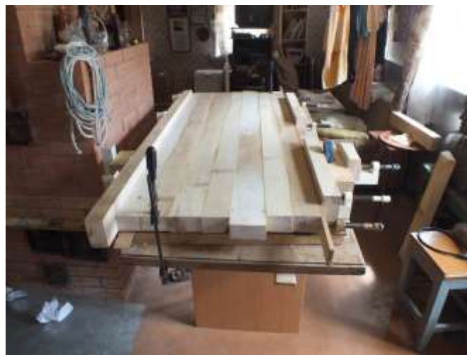
Рис. 4. Склеивание древесины. Широкий щит клеится в несколько этапов, по две-три доски за один раз. Качество обеспечивается более тщательным нанесением клея на боковые части бруска. Клей обязательно наносится на обе склеиваемые стороны бруса.
